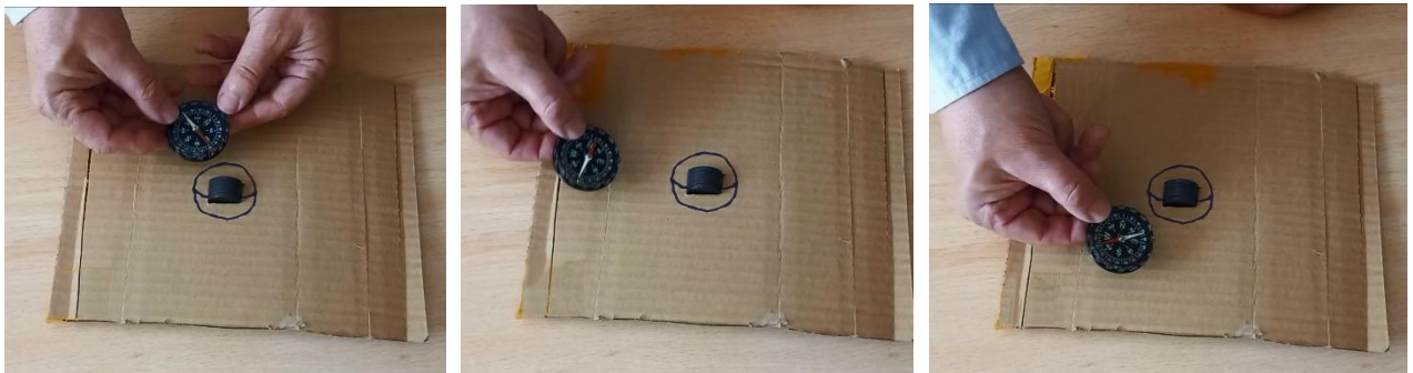
Fig. 17a, 17b, 17c: Con una brújula, las líneas de campo se “dibujan” (la aguja de la brújula siempre es tangente a las líneas de campo).
