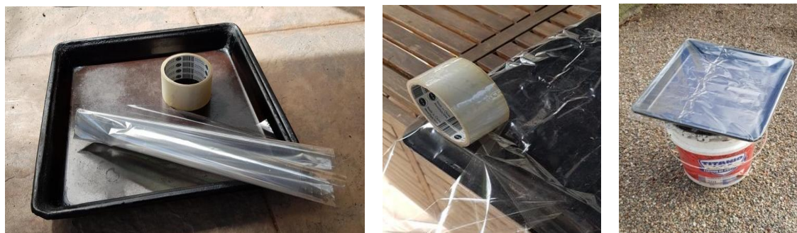
Fig. 28a: Bandeja, papel celofán y cinta para pegar, Fig. 28b: Pegando el papel de celofán en la parte posterior de la bandeja, Fig. 28c: “Trampa” de micrometeoritos instalada en el jardín.
