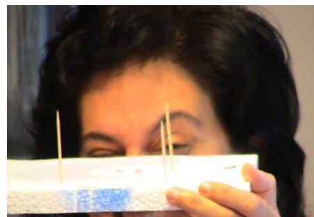
Fig. 7a y 7b: Como se usa el goniómetro horizontal
