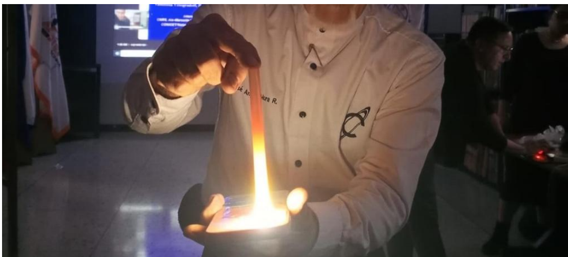
Fig. 25: La barrita de silicona termofusible cerca de la luz del móvil se ve de color azulado, pero en la zona más alejada, la luz se ve amarillenta y rojiza.
