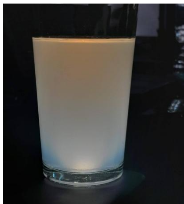
Fig. 24a: La luz de la linterna que sale por el lado del vaso se ve azulada.
