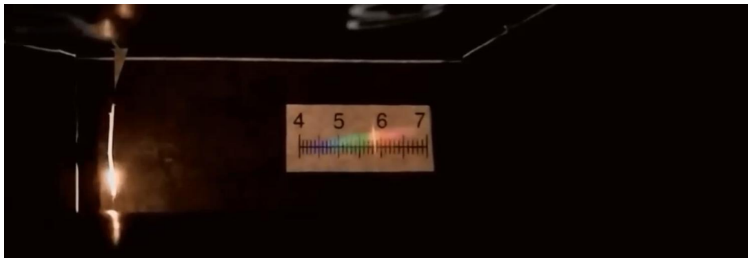
Fig. 6: Línea de emisión del Sodio
