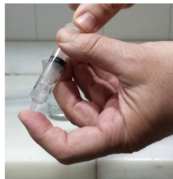
Fig. 11: A baja presión, el agua empieza a hervir a menos de 100° C
